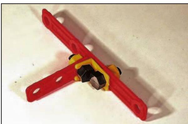
Так можно соединить две планки с помощью уголка и двух винтов.
